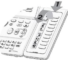
Ihr Telefon kann mit einem Erweiterungsmodul versehen werden. Es verfügt damit über zusätzliche als Funktionstasten, Leitungstasten, Kurzwahlstasten konfigurierbare Tasten usw.
